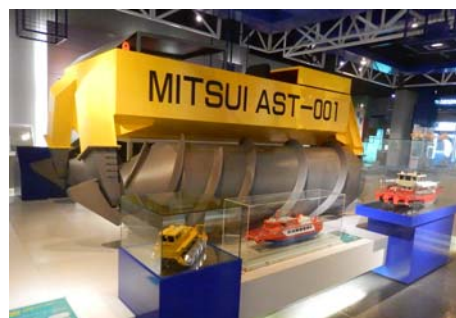
図 14. 海氷走行を目的としたアルキメディアンスクリュー実験機の実物大模型。
